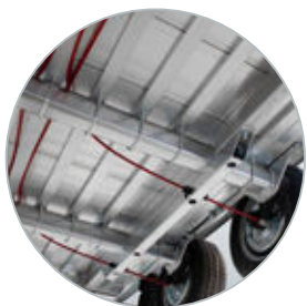
IJzersterke vloerondersteuning door vele kokerprofielen
